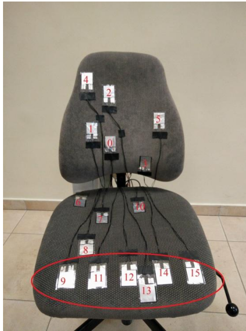
2.13 pav. Šiame tyrime naudojami A9, A11, A12, A13, A14 ir A15 jutikliai
