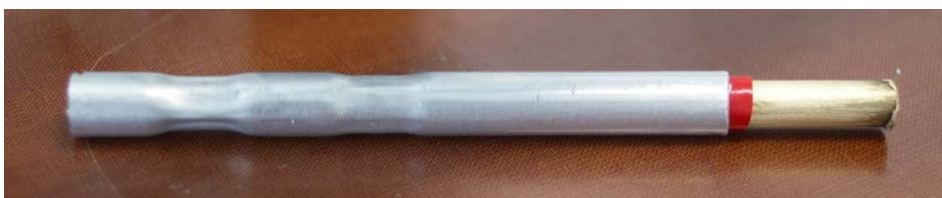
51 pav. Aliumininio 0,45 mm sienelės storio vamzdelio suvirinimas su žalvariniu 6 mm skersmens pilnaviduriu strypu
