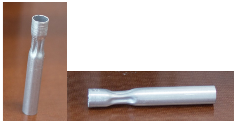
49 pav. Deformuotas aliumininis 8 mm skersmens 0,45 mm sienelės storio vamzdelis
