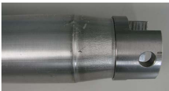
6 pav. Pavaros veleno jungtis, gauta elektromagnetini impulsiniu suvirinimo aparatu [19]
