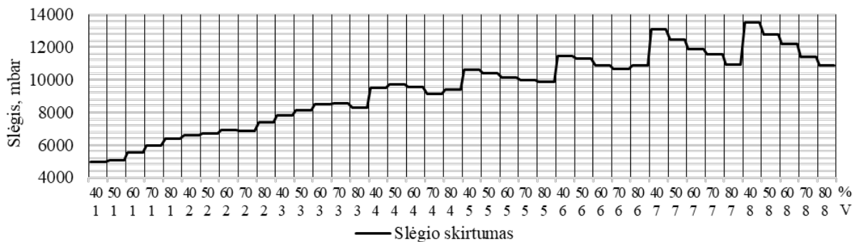
6 pav. Skirtumas tarp aukšto ir žemo freono slėgių esant skirtingiems droselio padėties ir tiekiamos įtamos deriniams.
