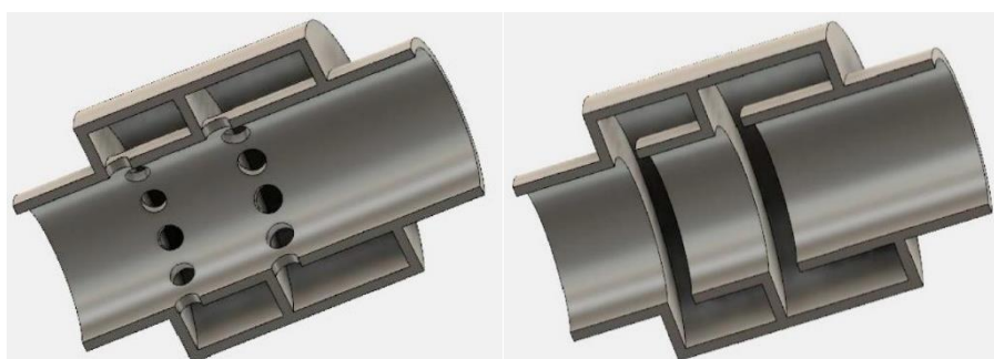
2.8 pav. CCR slopintuvas: kairėje – su perforuota konstrukcija, dešinėje – konstrukcija su įpjovomis
