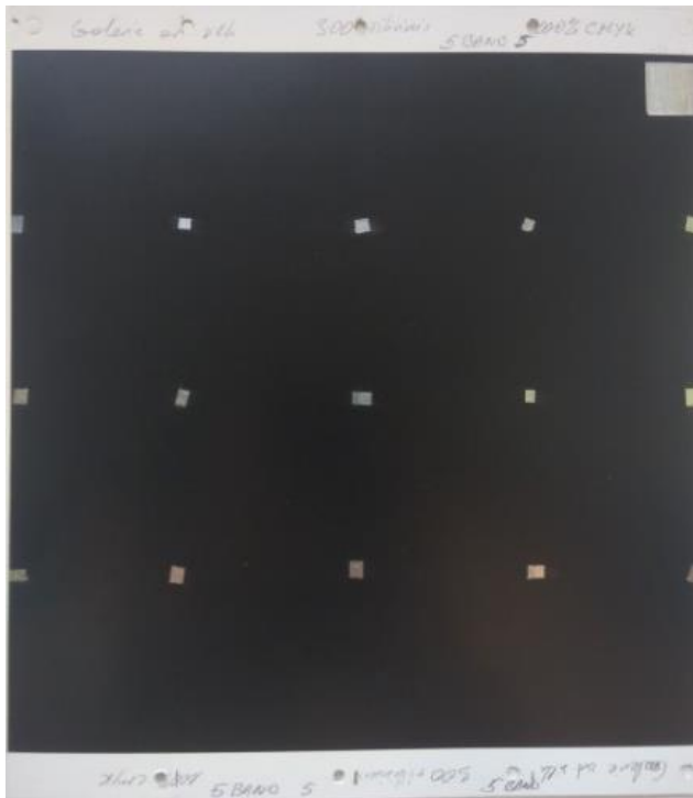
4.6 pav. Bandinys padengtas 100 proc. rašalo sluoksniu
