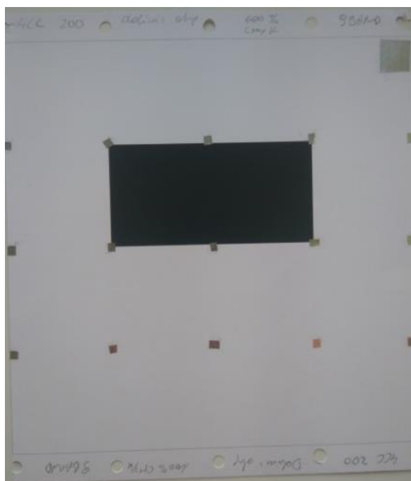
4.7 pav. Bandinys padengtas 14 proc. rašalo sluoksniu
