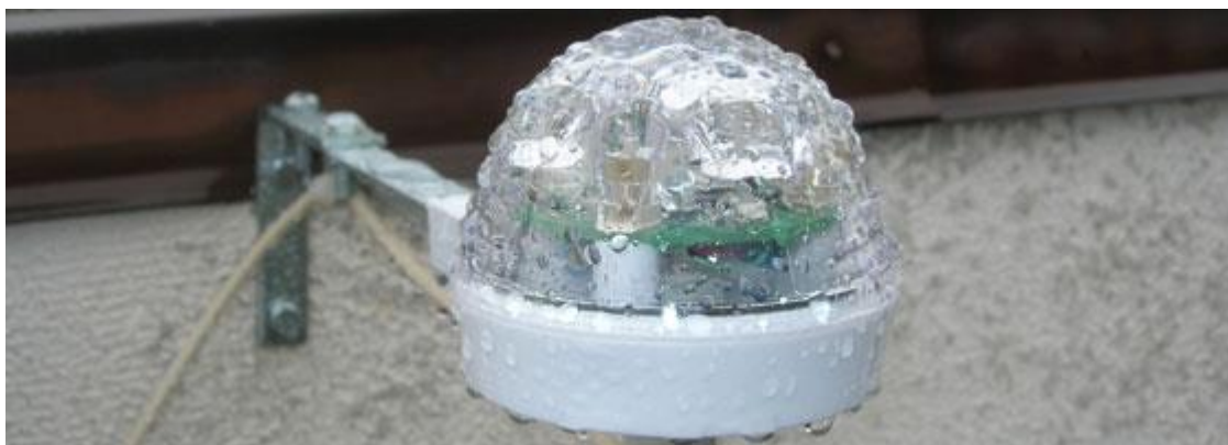
10 pav. Optinis kritulių jutiklis matuojantis šviesos išsklaidymą nuo skaidraus gaubto (Fondriest Staff, 2011)
