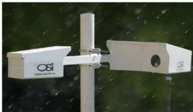
9 pav. Optinių kritulių jutiklio, kai yra šviesos šaltinis ir signalo priimtuvas, schema (Optical Scientific Inc., 2019)
