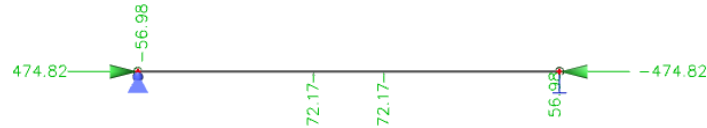
P.5.1 pav. Siją veikiančios jėgos bei momentai nuo stiprinimo sistemos poveikio
