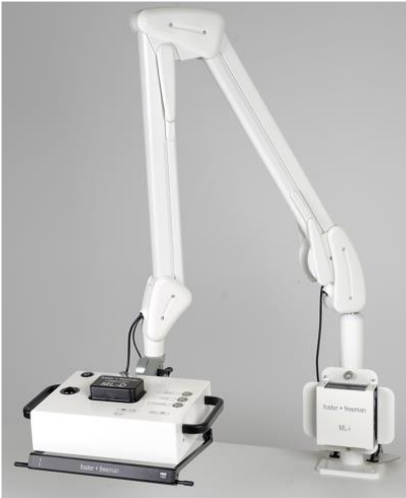
22 pav. Crime-lite MLD pirštų atspaudų ryškinimo technika.
