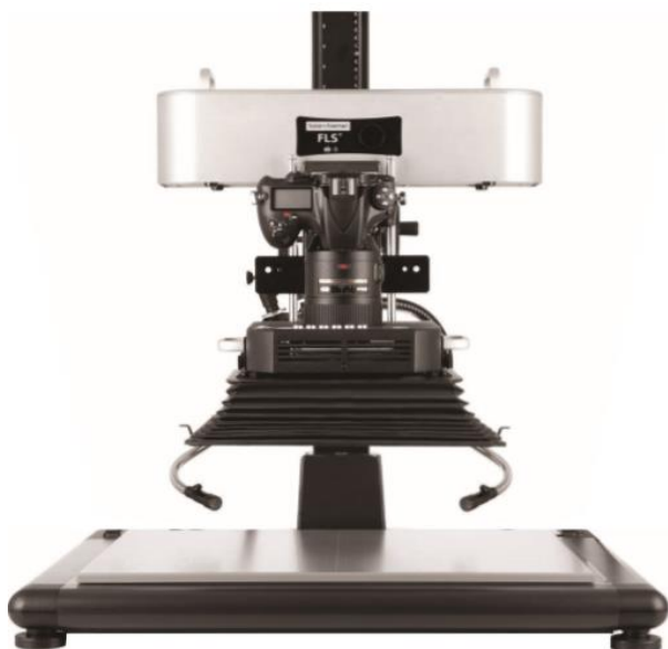
19 pav. DCS 5 pirštų pėdsakų vizualizavimo sistema
