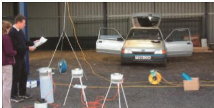
24 pav. SUPERfume kilnojamas įrenginys, skirtas įvykio vietos tyrimui 126 .
