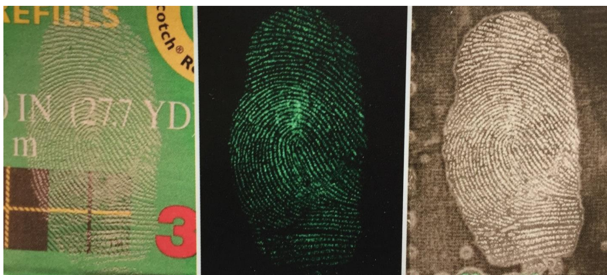
15 pav. Dengtas kartonas po apdorojimo fosforescuojančiais milteliais: a) apšviestas balta šviesa; b) 30 sekundžių po įkrovimo ultravioletiniais spinduliais (UV); c) perkeltas ir apšviestas balta šviesa 104 .
