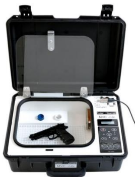
23 pav. MVC lite nešiojama garų kamera, skirta įvykio vietos tyrimui 125 .
