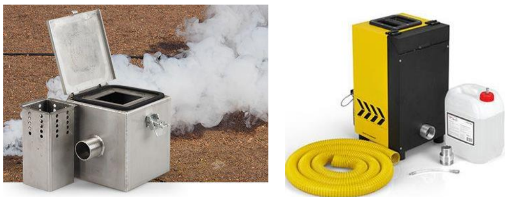
3.1 pav. Dūmų aparatas, stogų testavimui (Plokščio stogo...2015)
