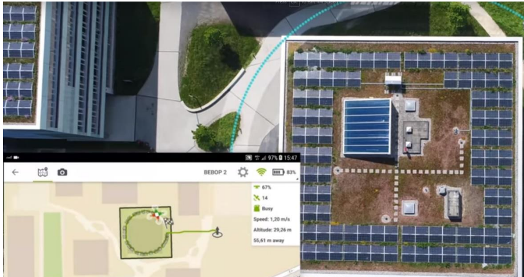
3.8 pav. Plokščio stogo tikrinimas bepiločiu orlaiviu (Stogo skaičiavimai...2017)
