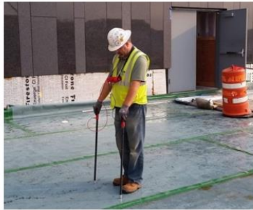
3.4 pav. Šlapias, elektros impulsais atliekamas, stogo testavimas (Stogo ir...2017)
