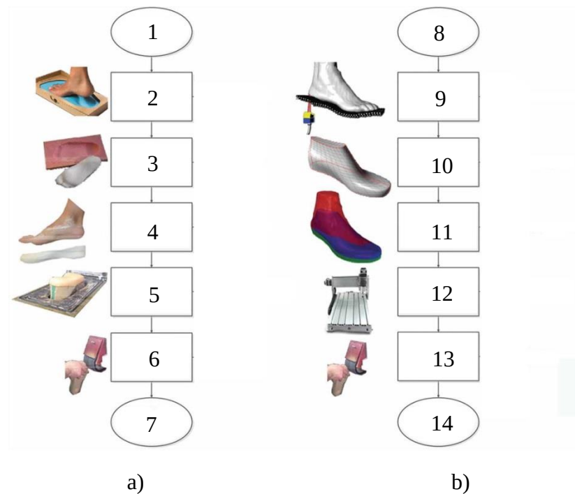
17 pav. Individualių ortopedinių vidpadžių gamybos metodai: a) klasikinis; b) šiuolaikinis (Mandolini et al. 2015)
