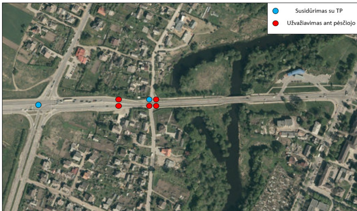
3.6 pav. Įskaitinių eismo įvykių išsidėstymo ruože schema
