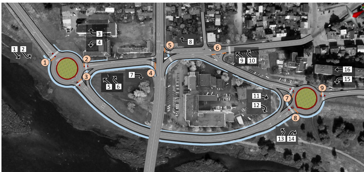
3.15 pav. Prastovų ir automobilių eilių ilgio matavimo krypčių numeracijos schema
