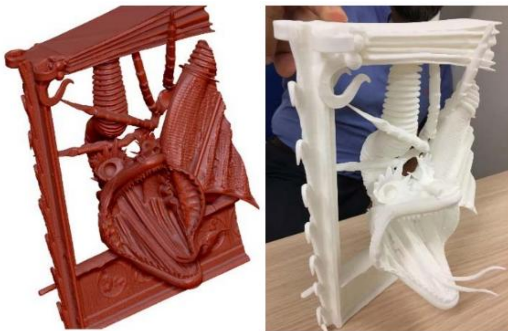
3 pav. „Gaudi’s Porta del Drac“ skulptūra. Skenuotas vaizdas ir SLS būdu pagaminta kopija
