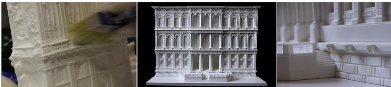
1 pav. SLS technologija atkurtas miniatiūrinis fasadas
