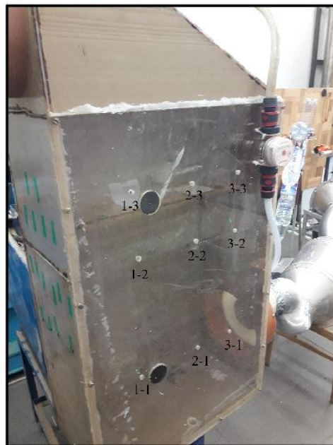
27 pav. Slėgio matavimo pozicijos absorberio konstrukcijos viduje
