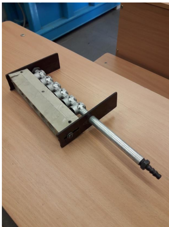
20 pav. Naudojamas Hartmano švilpukas
