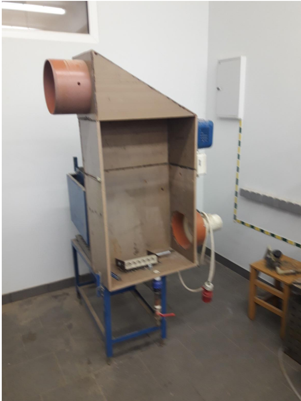
21 pav. Eksperimente naudojamas absorberis
