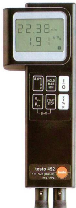
15 pav. TESTO 452 daigiafunkcis matavimo įrenginys
