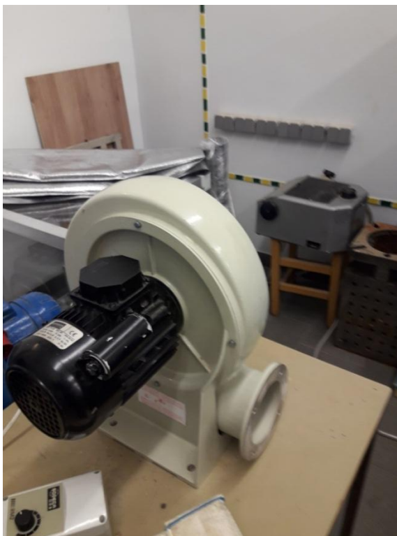
19 pav. Ventiliatorius su elektros pavara
