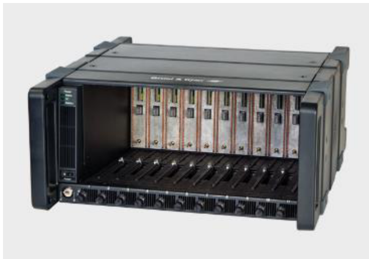
3.1 pav. „TYPE 3660-D - Brüel & Kjær“ duomenų kaupimo ir apdorojimo įranga (SYSTEM... 2012)
