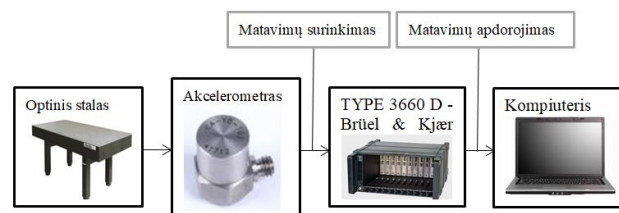
3 pav. Tyrimo stendo blokinė schema Fig. 3. Block scheme of experiment setup
