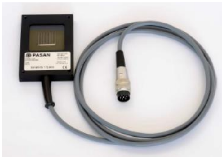
2.7 pav. PASAN A+ saulės šviesos simulatoriaus kontrolinė celė (Bordogna 2013)
