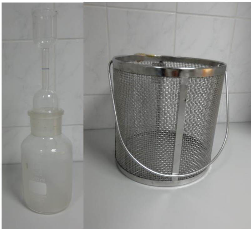
3.4 pav. Dalelių tankio nustatymo piknometras ir vielos krepšelis pagal standartą LST EN 1097-6:2013
