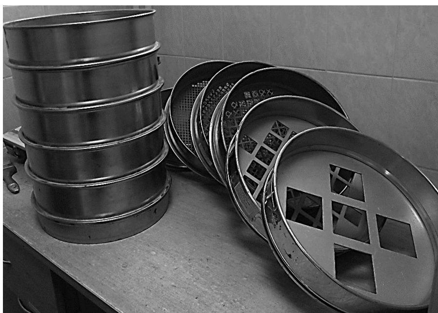
3.3 pav. Granulimetrinės sudėties nustatymo pagal standartą LST EN 933-1:2012 sietų rinkinys
