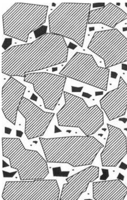
1.4 pav. Nesurištųjų mineralinių medžiagų sluoksnio skeleto schema
