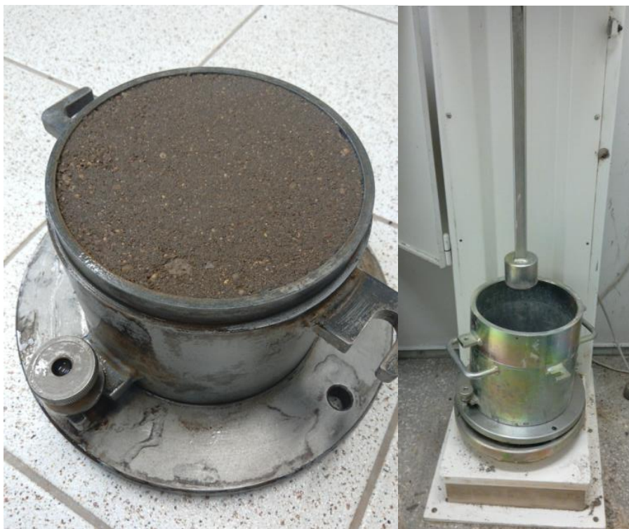
3.5 pav. Proktoro gilzėje sutankintas bandinys ir Proktoro tankinimo plūktuvas
