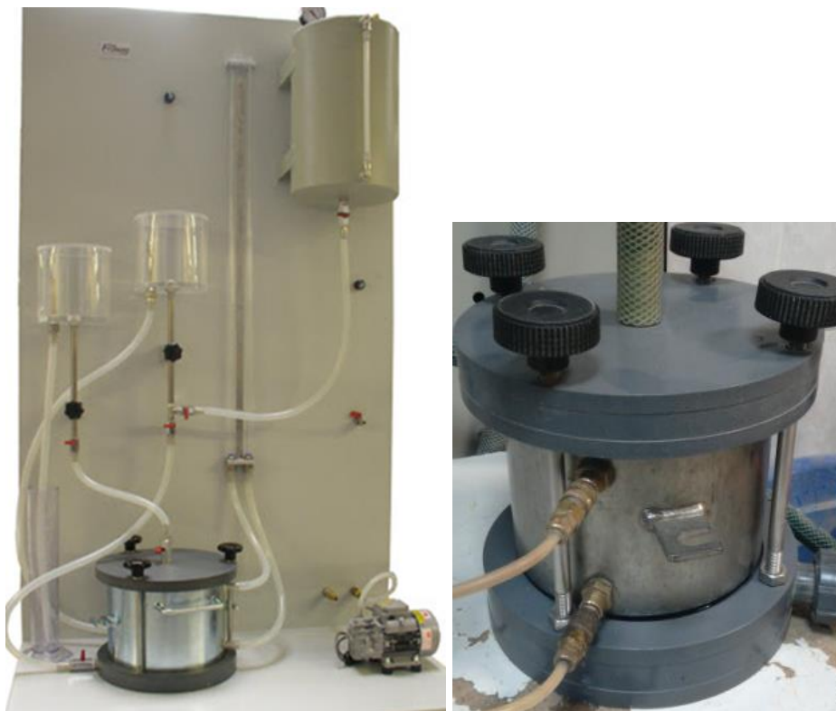
3.6 pav. Pralaidumo vandeniui bandymo sistema ir bandymui paruošta gilzė
