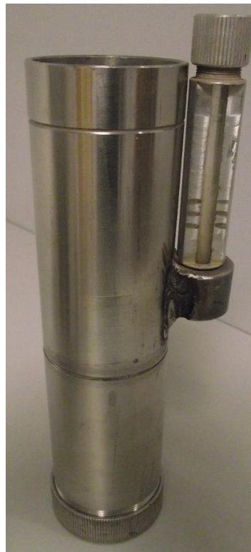
2.8 pav. a) Prietaiso filtracijos koeficientui nustatyti schema: 1 – žalvarinis dėklas; 2 – stiklinis vamzdelis; 3 – žalvarinis štuceri; 4 – metalinis indas vandeniui; 5 – vonelė; 6 – liniuotė-šablonas; 7 – žalvarinis cilindras; 8 – varinis tinklelis; 9 – žalvarinis disko formos skylėtas antgalis; 10 – žalvarinis padėklas; b) Prietaiso filtracijos koeficientui nustatyti cilindras
