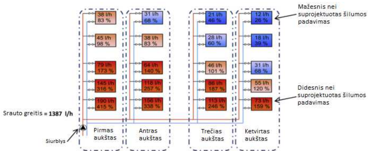
4 pav. Nesubalansuotos šildymo sistemos schema. (Ahern et al. 2015: 199–209)
