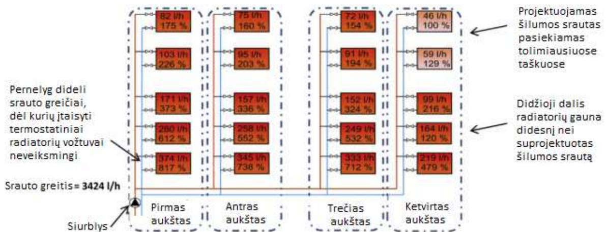
5 pav. Nesubalansuotos, perkaitamos šildymo sistemos schema. (Ahern et al. 2015: 199–209)
