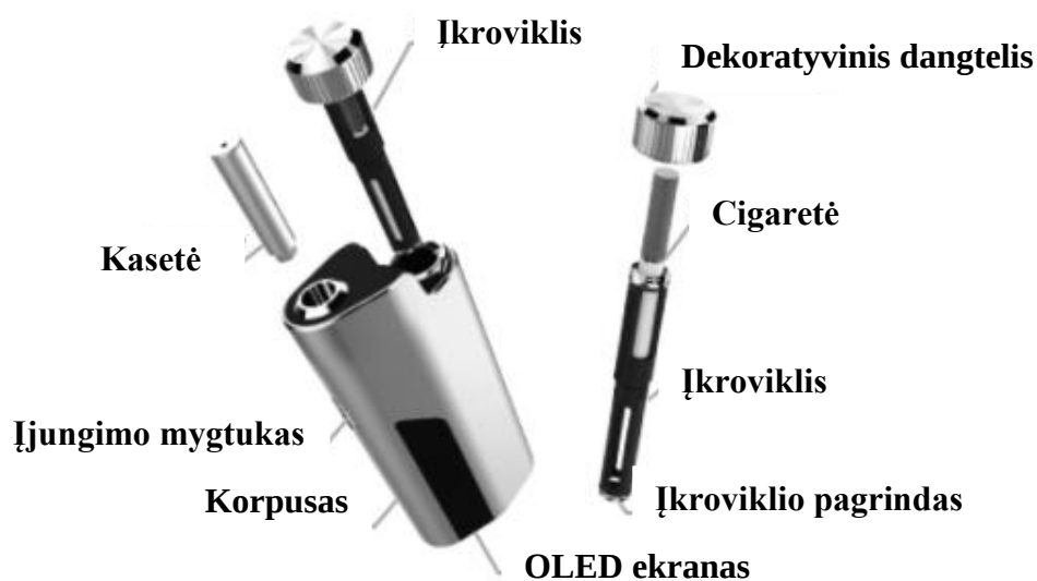
10 pav. Tabako kaitinimo sistemos išorinis vaizdas ir pagrindinės sudedamosios dalys [34]
