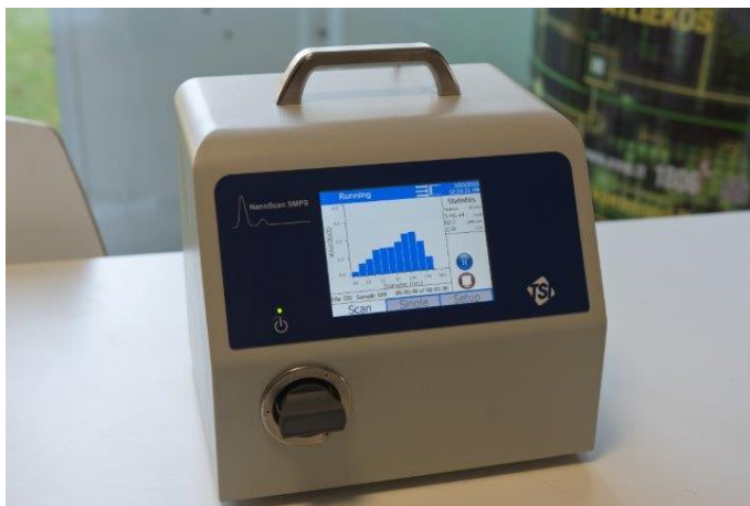
15 pav. Nanodalelių skaitinės koncentracijos matuoklis, Nanoscan SMPS nanoparticle sizer 3910
