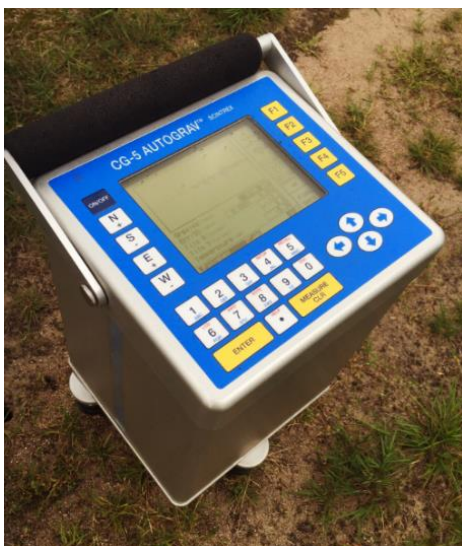
2.1 pav. Santykinis gravimetras Scintrex CG-5
