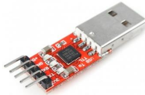
3.4 pav. CP2102 USB į TTL UART tiltas [33]
