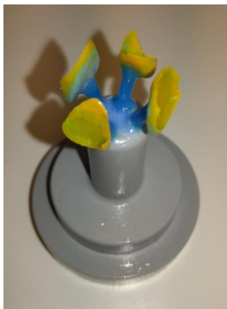
14 pav. Vaškinių konstrukcijų štiftavimas ir liečių sistemos statymas, ruošiant pakavimui žiede
