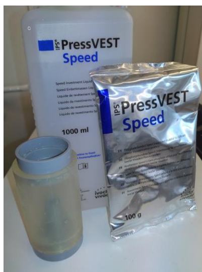
16 pav. Naudotas pakavimo žiedas ir pakavimo masė
