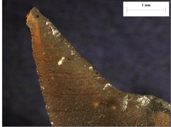
Pav. 65.1. Ylos smaigo paviršius padidintas 10x.
