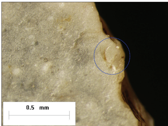
Pav. 32.1 Gremžtuko nugludintas darbinis paviršius padidintas 32x. Darbinės briaunos pažeidimo vieta pažymėta ■.
