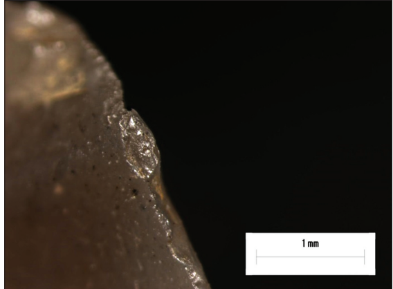
Pav. 96.1. Rėžtuko rėžiamasis kampas padidintas 16x.
