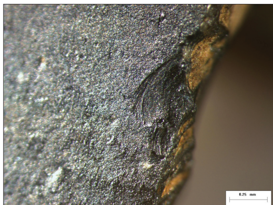
Pav. 22.1. Briaunos pažeidimas gręžimo metu. Dirbinio paviršius padidintas 50x.
