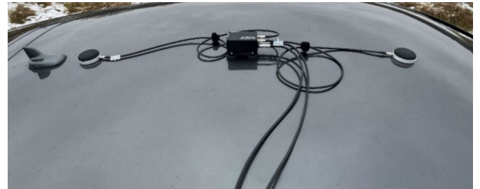
1 pav. „Navion i2“ matavimo prietaisas ant tiriamo automobilio Šaltinis: sudaryta autorių
