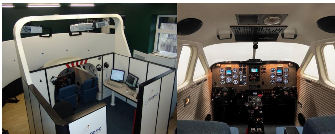
9 pav. „Mechtronix Systems Inc.“ skrydžio treniruoklis „Ascent FNPT II MCC“ (Vilnius Tech, autoriaus nuotraukos, 2025)
