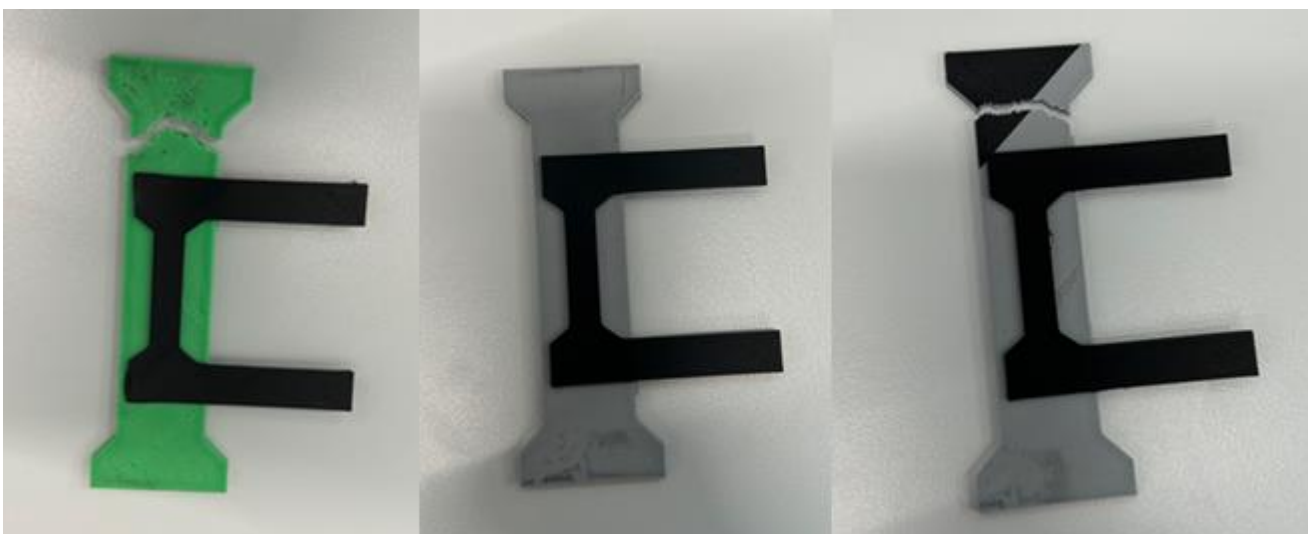
3.21 pav. Kombinuotų jutiklių bandiniai po deformacijos:
