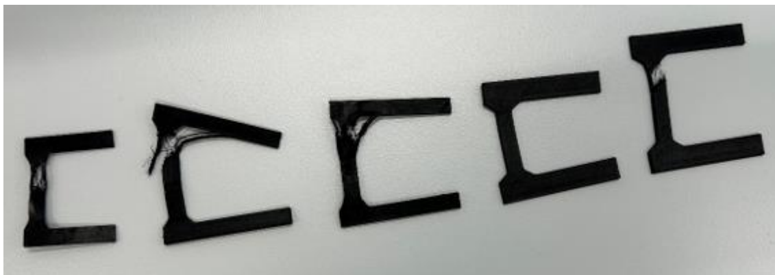
2.5 pav. Skirtingų matmenų jutikliai po deformacijos
