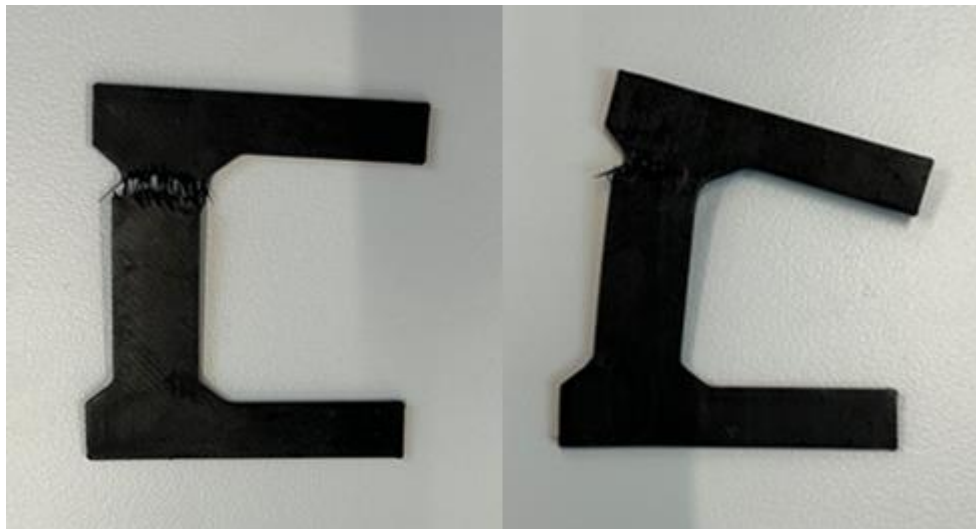
3.9 pav. 25×12×1,5 mm jutiklio bandiniai po deformacijos: a) jutiklis po pirmojo bandymo; b) jutiklis po antrojo bandymo
