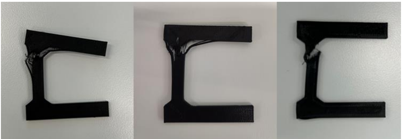
3.15 pav. 23×6×2 mm jutiklių bandiniai po deformacijos: a) jutiklis po pirmojo bandymo; b) jutiklis po antrojo bandymo; c) jutiklis po trečiojo bandymo
