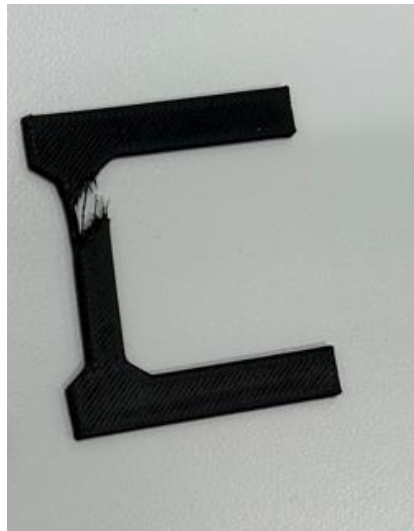
3.3 pav. 23×6×1,5 mm jutiklio bandinys po deformacijos
