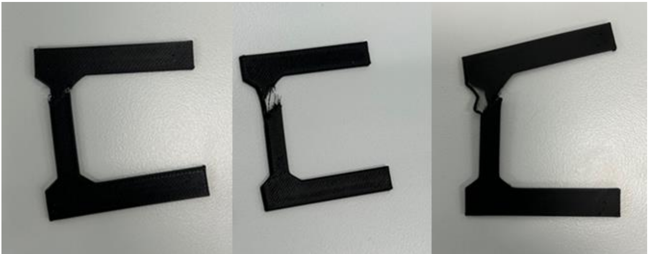
3.18 pav. 23×6×1,5 mm jutiklių bandiniai po deformacijos:
