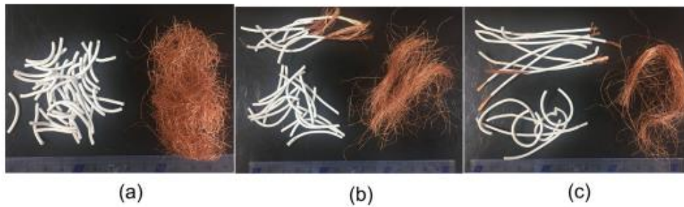
11 pav. Elektros kabelių, atskirtų maišant acetone, fotografiniai vaizdai: a) visiškai atskirti 3 cm kabeliai, b) 71 % atskirti 5 cm kabeliai ir c) 48 cm atskirti 8 cm kabeliai ir c) 48 % atskirti 8 cm kabeliai (Xu ir kt., 2019)
