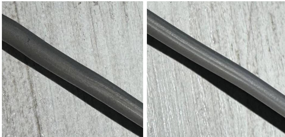
36 pav. PVC izoliacinė medžiaga, kaitinamo veleno temperatūra 150°C, kairėje greitis 0,1 m/s, dešinėje greitis 0,05 m/s
