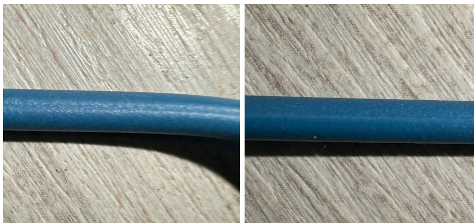
39 pav. PE izoliacinė medžiaga, kaitinamo veleno temperatūra 250°C, kairėje greitis 0,1 m/s, dešinėje greitis 0,05 m/s
