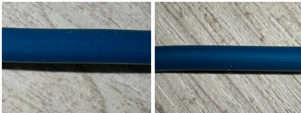
44 pav. PTFE izoliacinė medžiaga, kaitinamo veleno temperatūra 150°C, kairėje greitis 0,1 m/s, dešinėje greitis 0,05 m/s
