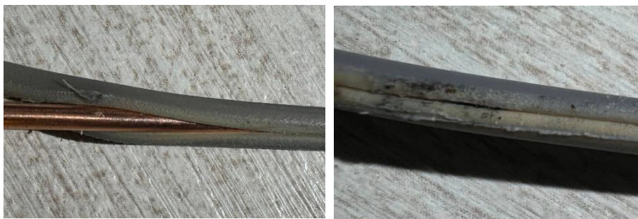
38 pav. PVC izoliacinė medžiaga, kaitinamo veleno temperatūra 250°C, kairėje greitis 0,05 m/s, dešinėje greitis 0,1 m/s
