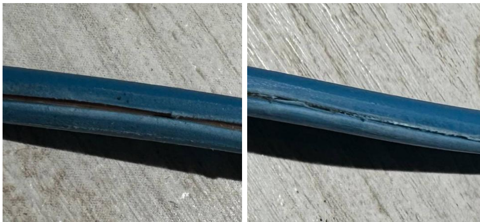
42 pav. PE izoliacinė medžiaga, kaitinamo veleno temperatūra 250°C, kairėje greitis 0,05 m/s, dešinėje greitis 0,1 m/s
