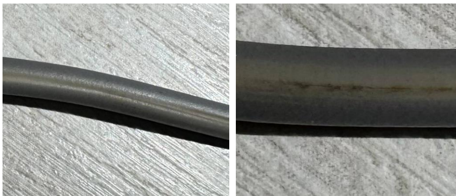
37 pav. PVC izoliacinė medžiaga, kaitinamo veleno temperatūra 200°C, kairėje greitis 0,05 m/s, dešinėje greitis 0,1 m/s
