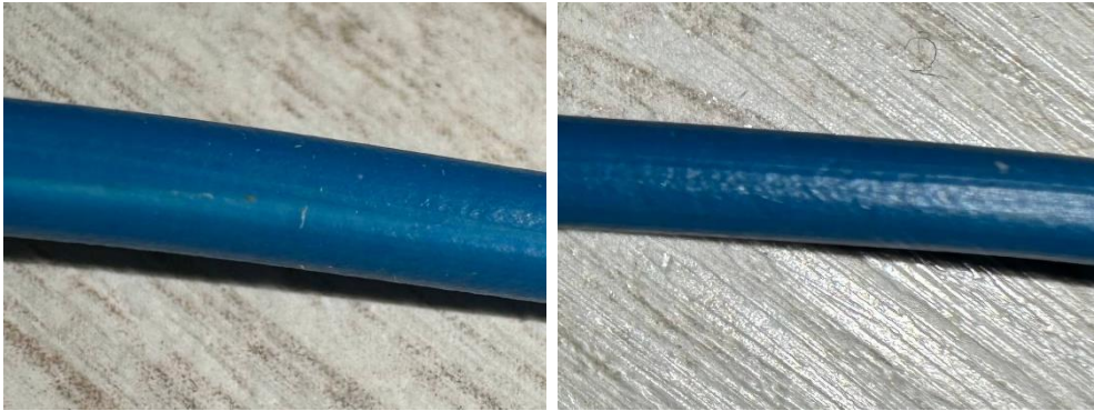
45 pav. PTFE izoliacinė medžiaga, kaitinamo veleno temperatūra 200°C, kairėje greitis 0,05 m/s, dešinėje greitis 0,1 m/s
