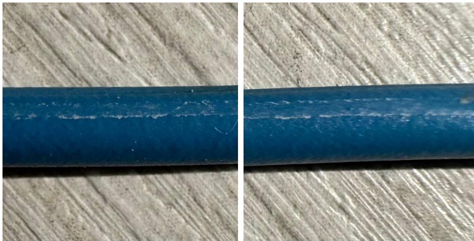
41 pav. PE izoliacinė medžiaga, kaitinamo veleno temperatūra 200°C, kairėje greitis 0,1 m/s, dešinėje greitis 0,05 m/s
