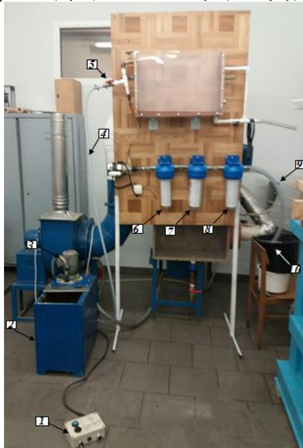
5 pav. Eksperimentinio stendo nuotrauka: 1 – įjungimo/išjungimo mygtukas; 2 – NP užteršto vandens talpa; 3 – siurblys; 4 – lanksti žarna, kuria NP užterštas vanduo tiekiamas į pirmąjį filtrą; 5 – vožtuvas; 6 – pirmasis filtras; 7 – antrasis filtras; 8 – trečiasis filtras; 9 – lanksti žarna, 10 – mėginių paėmimo vieta.
