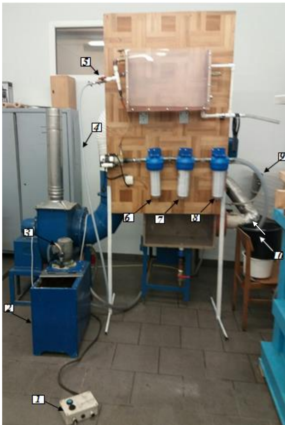
3.2. pav. Eksperimentinio stendo nuotrauka: 1 – įjungimo/išjungimo mygtukas; 2 – NP užteršto vandens talpa; 3 – siurblys; 4 – lanksti žarna, kuria NP užterštas vanduo tiekiamas į pirmąjį filtrą; 5 – vožtuvas; 6 – pirmasis filtras; 7 – antrasis filtras; 8 – trečiasis filtras; 9 – lanksti žarna, 10 – mėginių paėmimo vieta.
