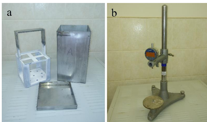
2.2 pav. Šarminės korozijos tyrimams naudojama įranga: a) nerūdijančio plieno konteineris; b) skaitmeninis indikatorius ir rėmas
