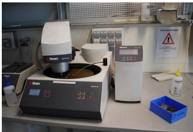
2.2 pav. „Stuer tegraforce 5“ automatinė šlifavimo mašina
