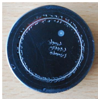
3.21 pav. Deimantinės dangos, padengtos C_2H_2 dujų aplinkoje, tribologinis bandymas: proceso temperatūra 575 °C, 1.7225 substratas
