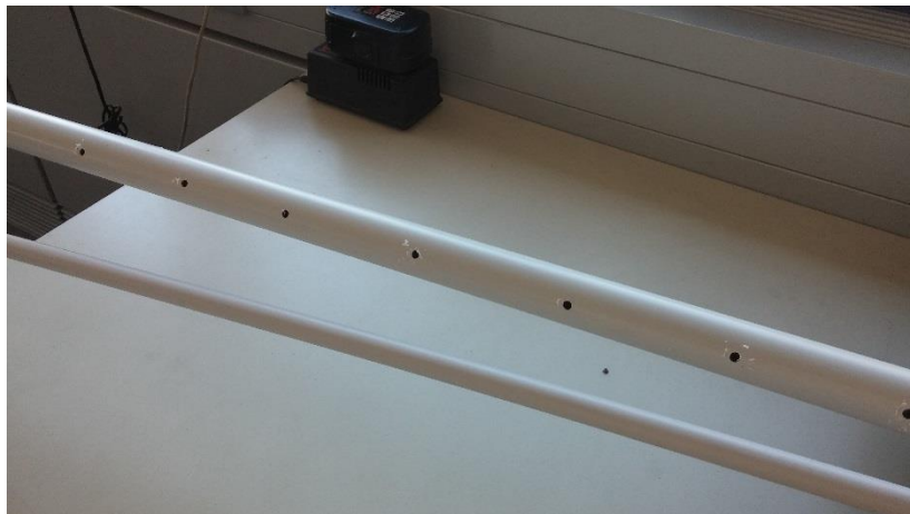
2.17 pav. DLC dangų smūgio bandymo stendas
