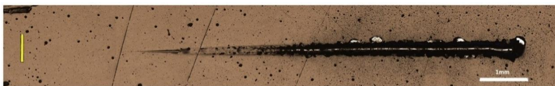
3.15 pav. Deimantinės dangos įbrėžimo bandymas: proceso temperatūra 575 °C, 1.7225 substratas, kritinė apkrova 51 N
