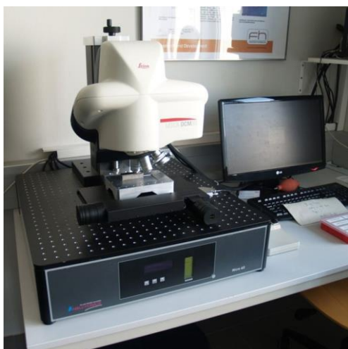
2.20 pav. „Leica DCM3D“ konfokalinis mikroskopas optiniams ir interferometriniais paviršiams matuoti
