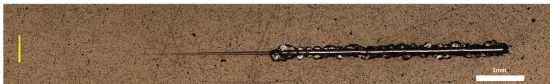
3.16 pav. Deimantinės dangos įbrėžimo bandymas: proceso temperatūra 575 °C, 1.3343 substratas, kritinė apkrova 54 N
