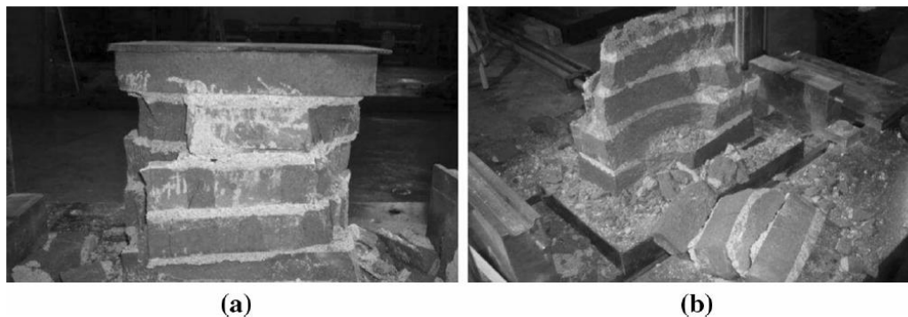
1.10 pav. Mūro prizmių suirimo charakteris:
