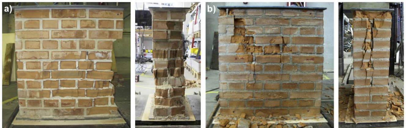
1.9 pav. Mūro fragmentai po suirimo (Sassoni et al. 2014)
