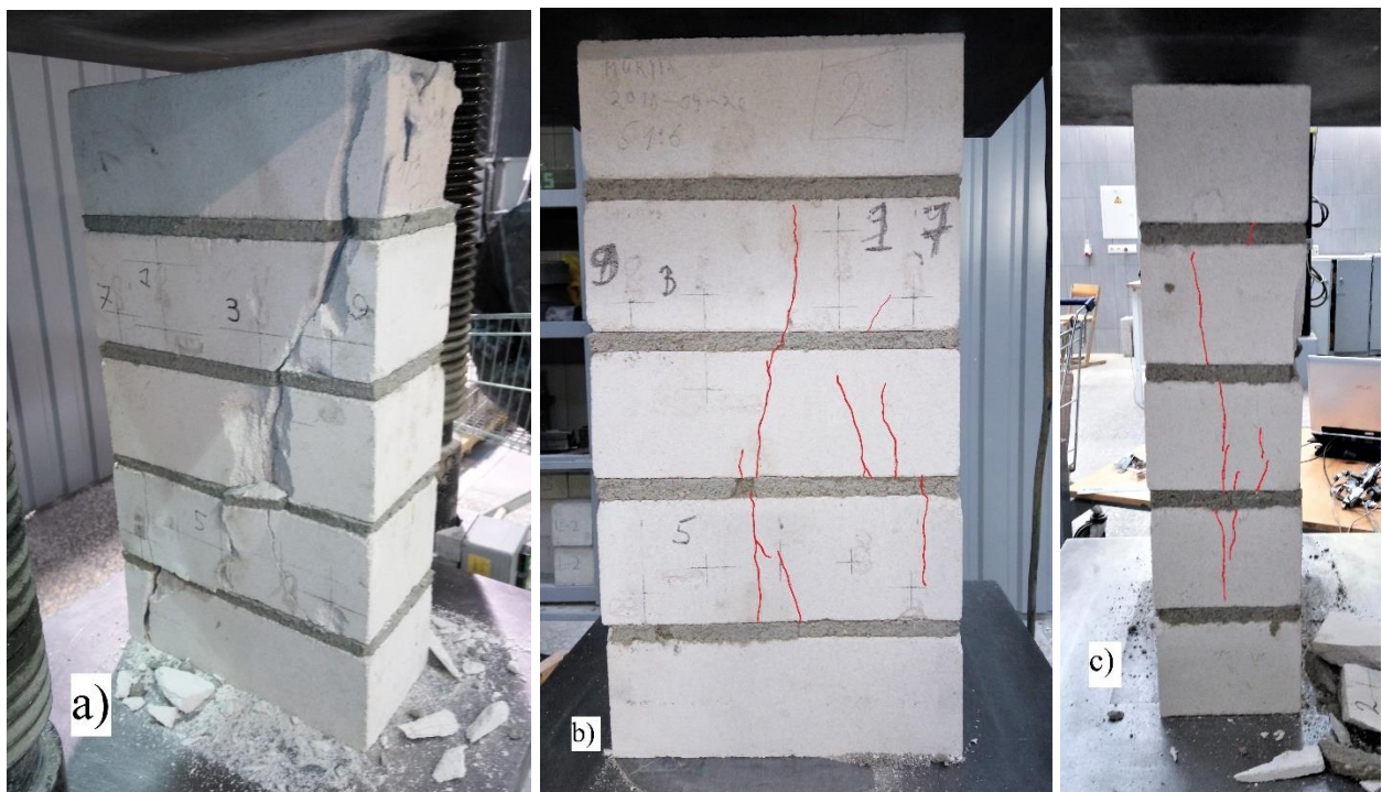
3.4 pav. Mūro fragmentai po suirimo: a) mūro irties pobūdis kai naudojamas skiedinys M1, b), c) mūro irties pobūdis kai naudojamas skiedinys M2
