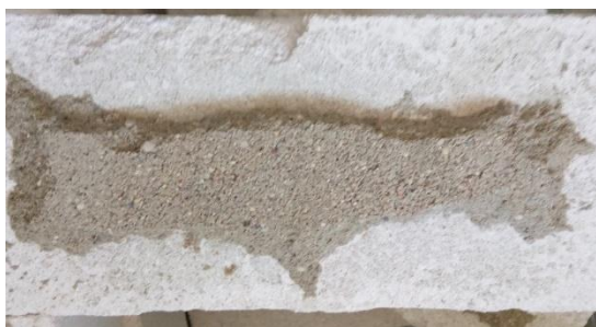
2.7 pav. Stipri gulsčiosios siūlės sukibties zona, kai sunkiai atskiriama skiedinio plokštelė nuo mūro gaminio
