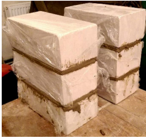
2.10 pav. Mūro bandiniai su plėvelės intarpu
