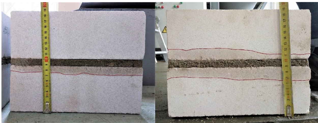
2.6 pav. Mūro bandinių fragmentai su viena gulsčiaja siūle. Kairėje panaudotas M1 skiedinys, dešinėje M2
