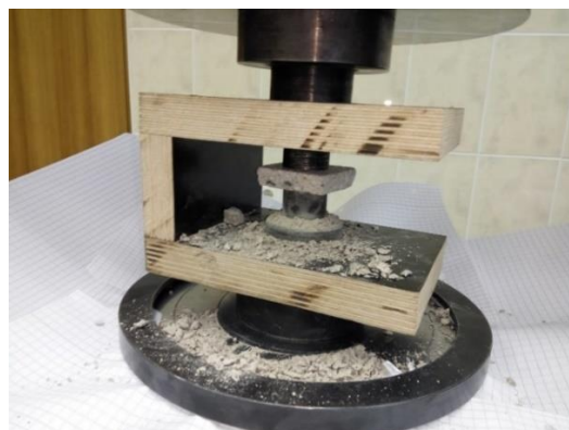
2.9 pav. Dvipusio gniuždymo tyrimas
