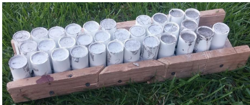
2.2 pav. Pagaminti bandiniai PVC vamzdžiuose
