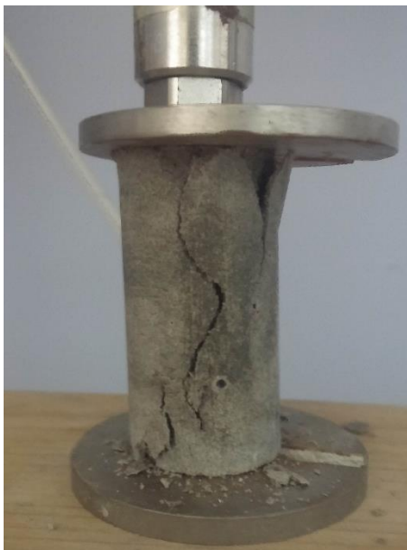
2.7 pav. Sugniuždytas bandinys be lakiųjų pelenų po 7 parų laikant bandinį orinėje terpėje
