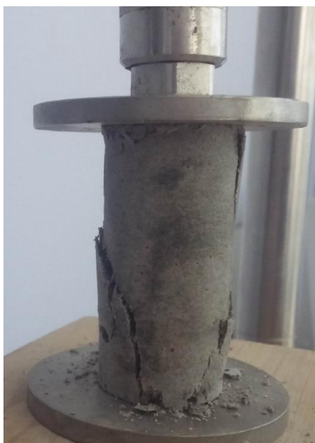
2.8 pav. Sugniuždytas bandinys be lakiųjų pelenų po 7 parų laikant bandinį vandenyje
