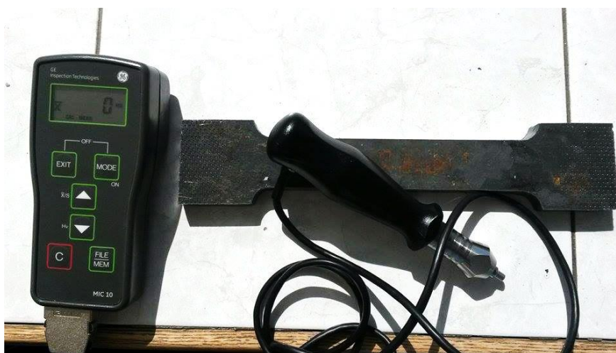
2.2 pav. Bandinių kietumo matavimas kietmačiu MIC10
