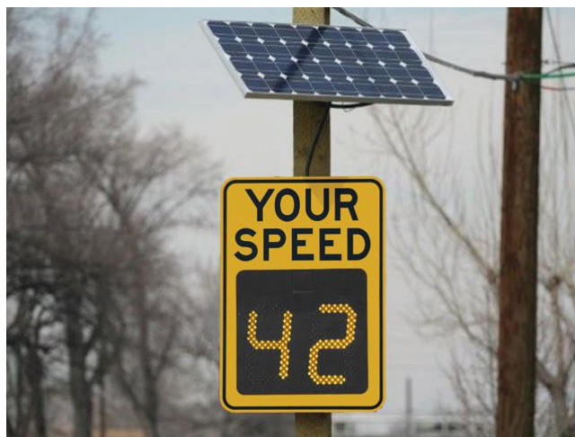
2.13 pav. Momentinio greičio ekranas (www.marketwired.com)
