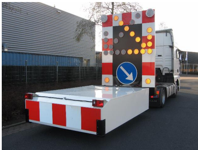
2.11 pav. Transporto priemonė su smūgi absorbuojančia pagalve ir įspėjamaisiais ženklais ( www.trafficsafetysystems.eu )
