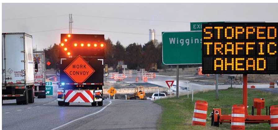
2.7 pav. Kilnojamasis kintamosios informacijos kelio ženklas (tti.tamu.edu)
