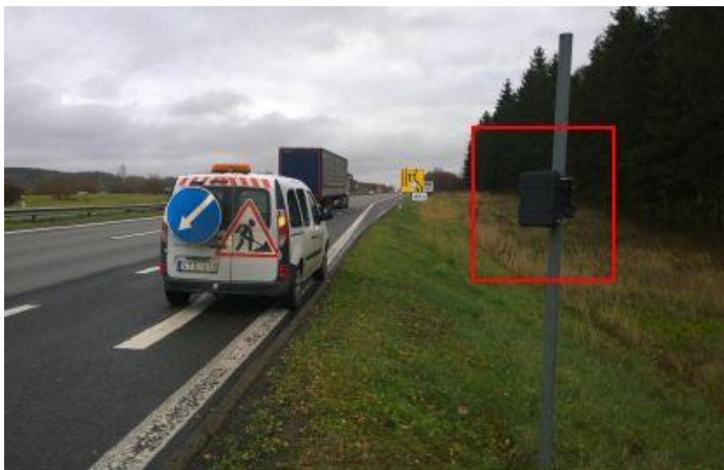
3.2 pav. Transporto priemonių greičio matavimo ir klasifikavimo prietaisas „Datacollect“ (fotografuota D. Skrodenio, 2015)
