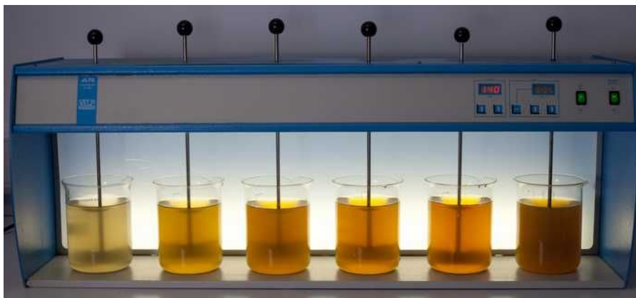
5 pav. Laboratorinė maišyklė skirta indelių metodo tyrimui (Burgess, 2015)
