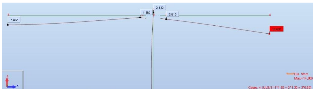
5.3 pav. Rėmo suminiai vektoriniai poslinkiai, atitinkantys skaitinį modelį, SolidWorks programa
