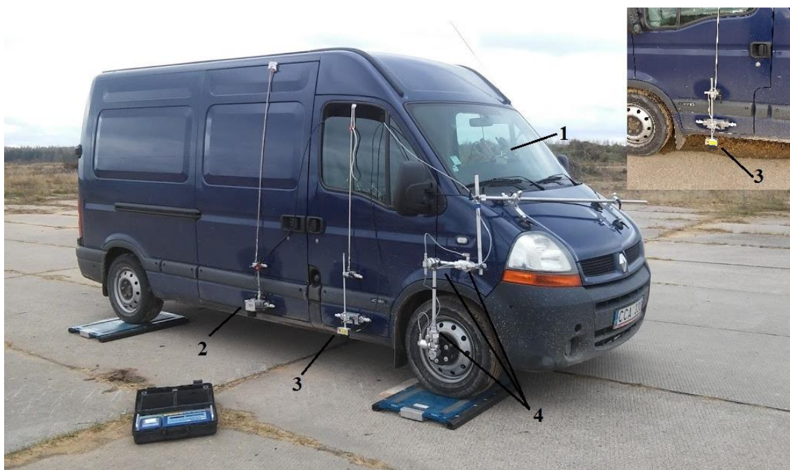
3.7 pav. Jutiklių matavimo schema: 1 – akcelerometras ir giroskopas; 2 – optinis greičio jutiklis; 3 – lazerinis posvyrio jutiklis; 4 – rato padėties jutikliai
