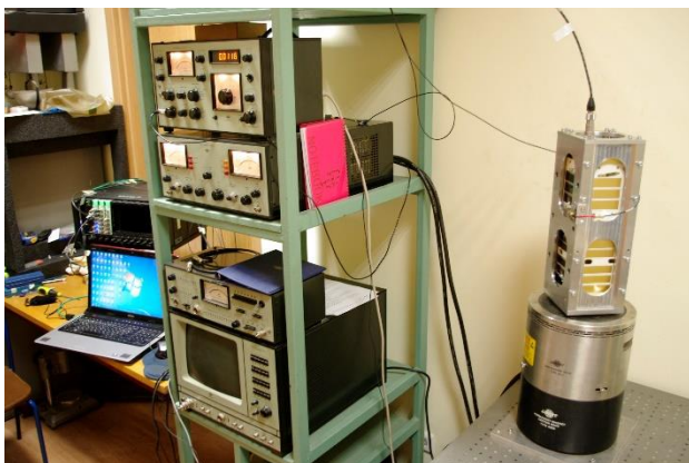
Pav. 4 Palydovo dinaminio savybių tyrimo stendas
