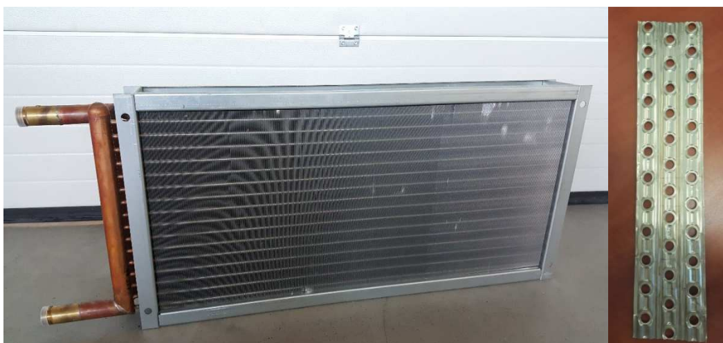
Pav. 11 Bandomasis šilumokaitis ir naudojama šilumokaičiuose plokštelė
