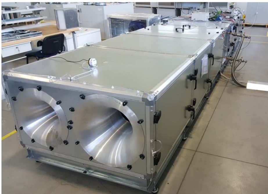
Pav. 7 Šilumokaičių bandymų stendas
