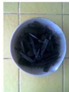
3 pav. Pabėgių pirogeninis karbonatingas produktas, pagamintas 450 °C temperatūroje
