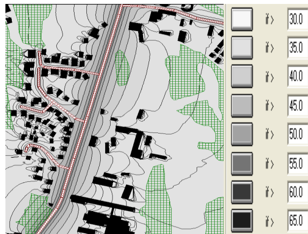
5 pav. Triukšmo sklaida pietinėje miesto dalyje nakties metu Fig. 5. Noise dispersion in the southern part of the city at night
