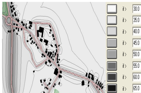
9 pav. Triukšmo sklaida šiaurinėje miesto dalyje nakties metu Fig. 9. Noise dispersion in the northern part of the city at night
