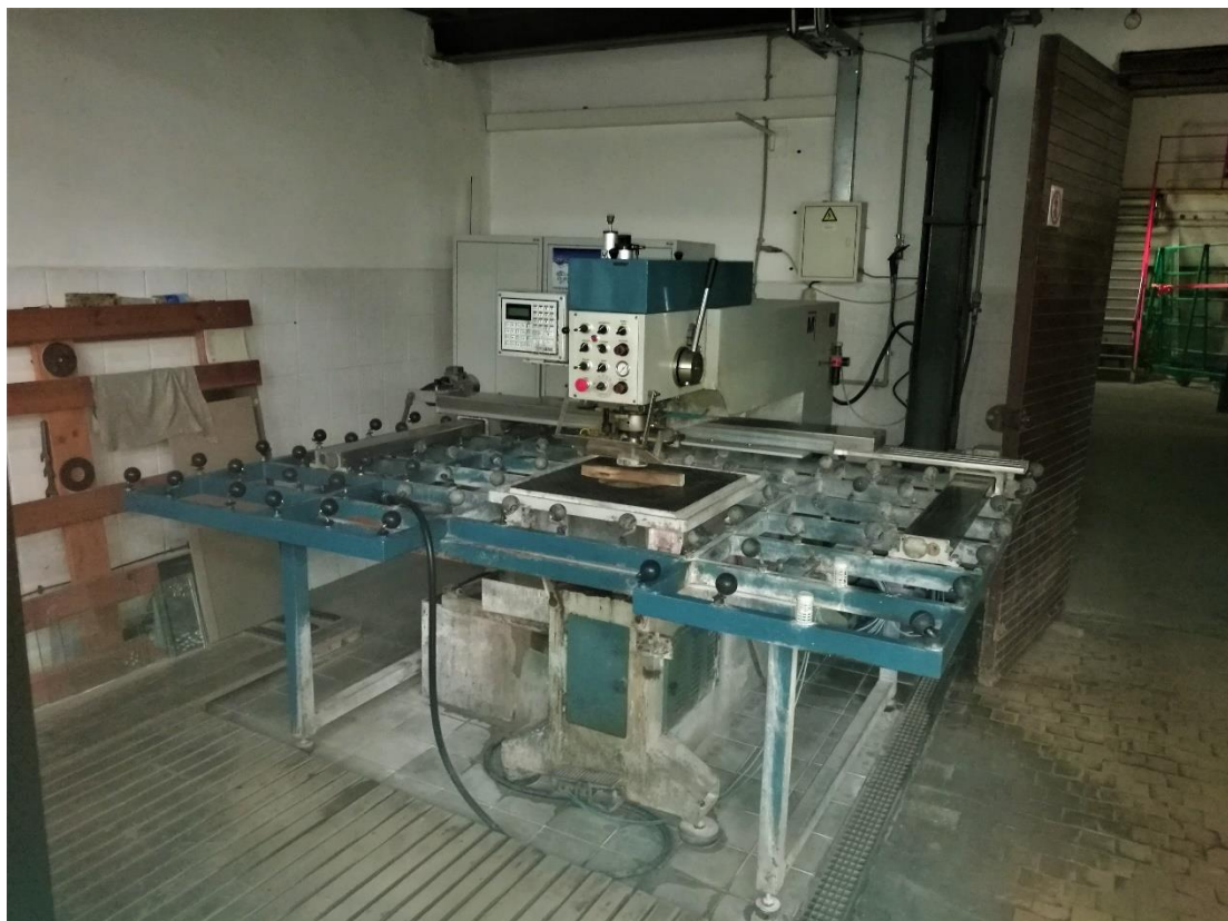
Grėžimas su pozicionavimo sistema
