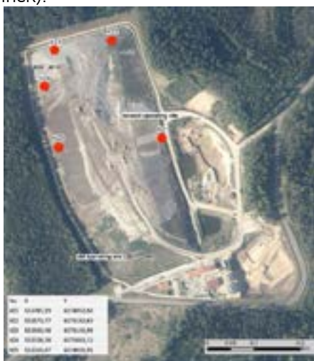
Figure 1. Kazokiškės landfill soil sampling plan.
