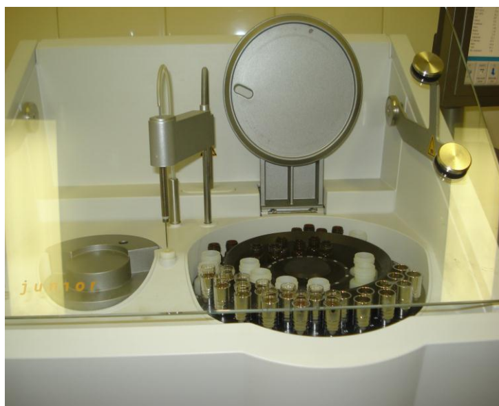
3pav. SELECTRA Junior automatinis biocheminis analizatorius
