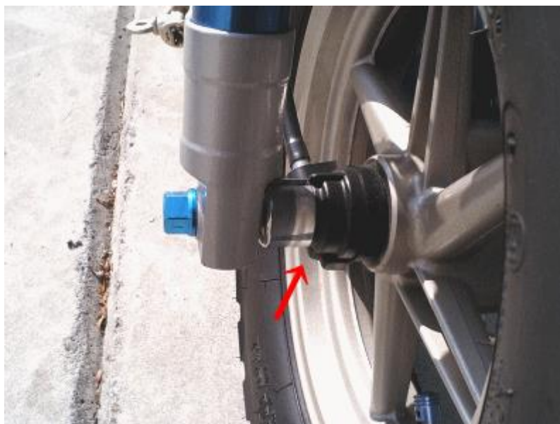
2.2.2. pav. Pavara ir jo tvirtinimo vieta.
