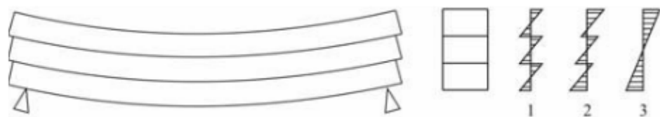
1.7 pav. Skirtingos sąveikos tarp sluoksnių įtaka įtempių pasiskirstymui skerspjuvyje: 1 – nėra sąveikos; 2 – dalinė sąveika; 3 – visiška sąveika (Marčiukaitis, Valivonis 2007)
