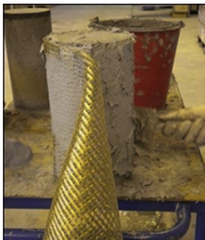
1.19 pav. Fenilen benzobis oksazolo tinkle impregnuoto cemento uždėjimas (Colajani et al. 2014)
