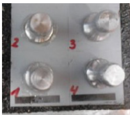
26 pav. Medžiagos nr.5 priklijuoti bandiniai
