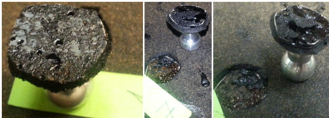
20 pav. Atplėšti bituminės dangos bandiniai
