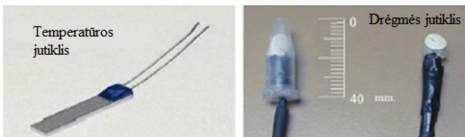
2 pav. Temperatūros, drėgmės jutikliai (Sanchez et al. 2010)
