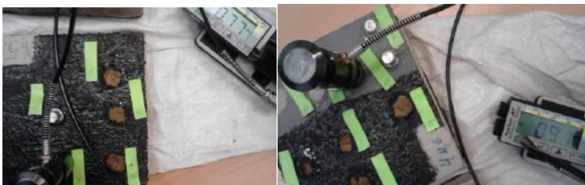
25 pav. Medžiagos nr.3, 4 bandinių atplėšimas
