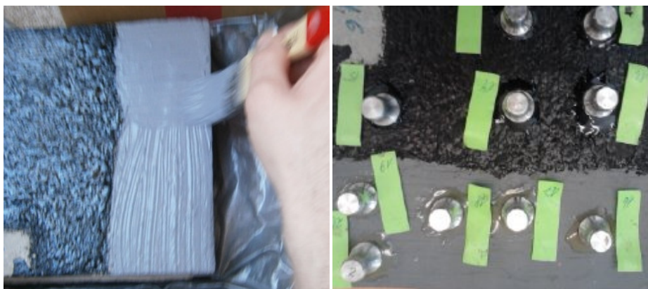
24 pav. Medžiagos nr.3, 4 paruošimas bandymui
