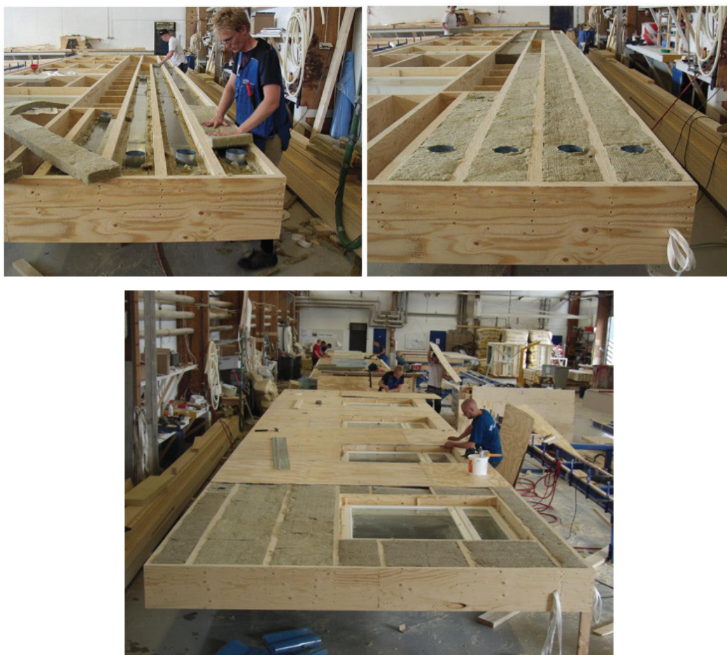
12 pav. Gamykloje gaminami specialūs skydai („Inova“ projektas... 2013)
