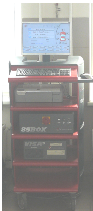
19 pav. Stabdžių efektyvumo patikros stendas 85BOX Tecnotest
